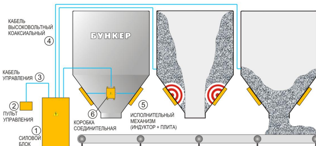
Рис.1 Оснащение бункеров магнитно-импульсной системой сводообрушения на базе установки ИМ.
